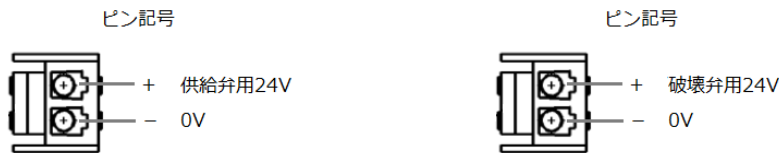
バルブ用コネクタのピン配置（供給弁用コネクタのリード線に VAC 表記あり）
