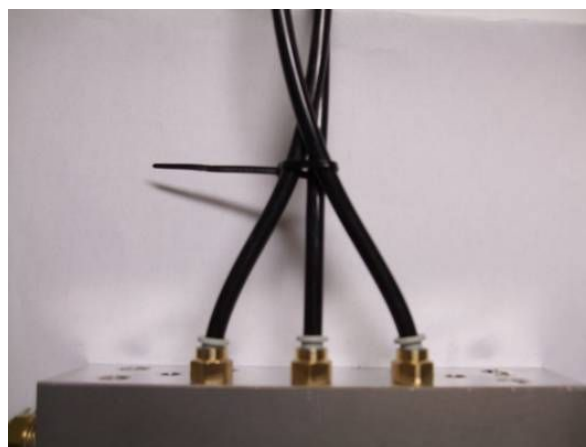
図2 結束バンドで配管を束ねた場合
