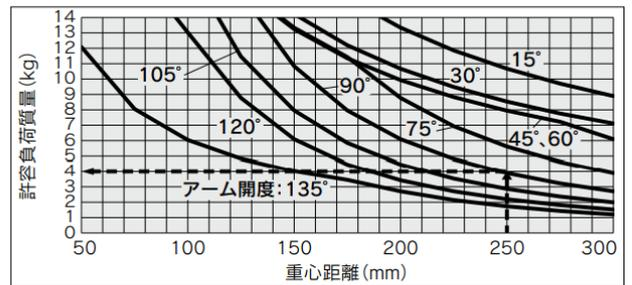
**算出例** チューブ内径63、アーム開度90°で、重心距離Lが250mmの場合
