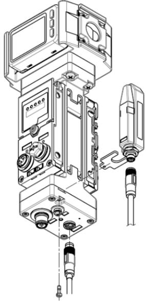
無線アダプタに取付けられている M10 ナットを使い、エアマネジメントハブ付属の固定金具へ取付けます。トルクは 0.9 ±10% Nm で締付けてください。
