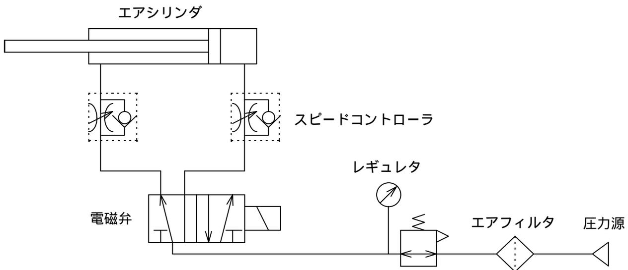
シリンダが複動タイプの場合、スピードコントローラは、メーターアウト制御のものを使用してください。
