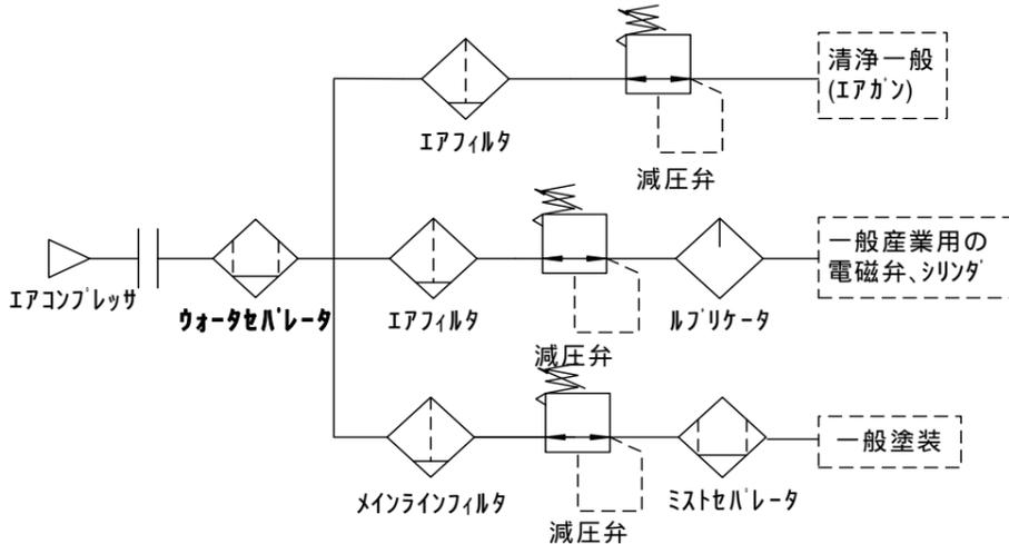
図1. 用途例とライン構成例
