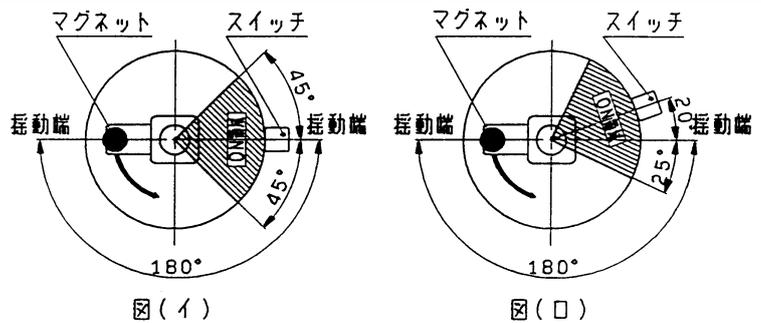
上図(イ)において、マグネットが→印方向へ揺動するとスイッチの取付している揺動端 $45^\circ$ 手前からスイッチがONします。今仮に、スイッチを図(ロ)に示しますように $20^\circ$ ずらしたとすると、スイッチがONする位置を揺動端 $25^\circ$ 手前に変更することができます。
