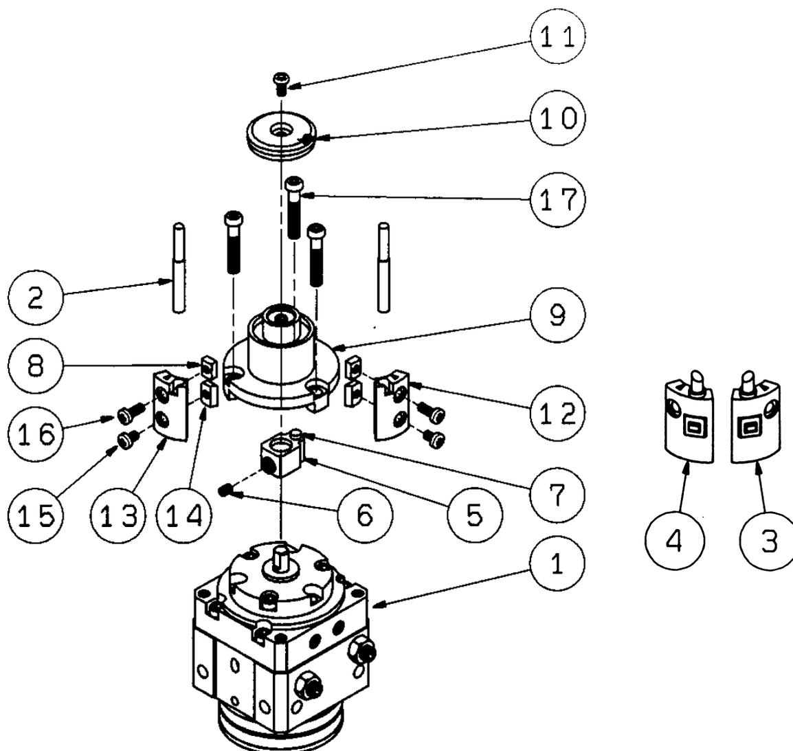
図9 MSUA 1・3スイッチユニット内部構造
