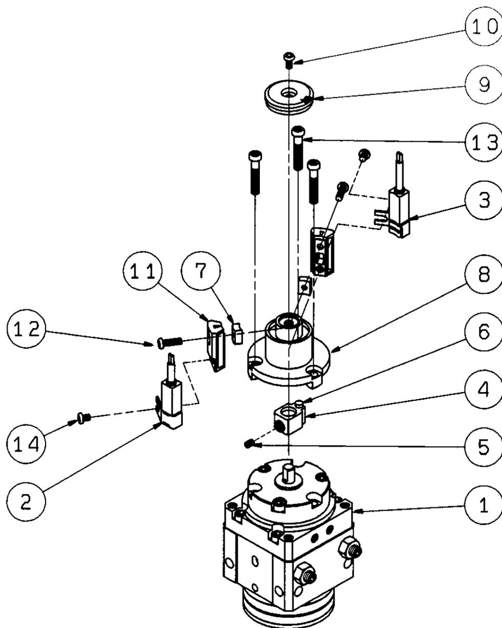
図10 MSUA7・20スイッチユニット内部構造
