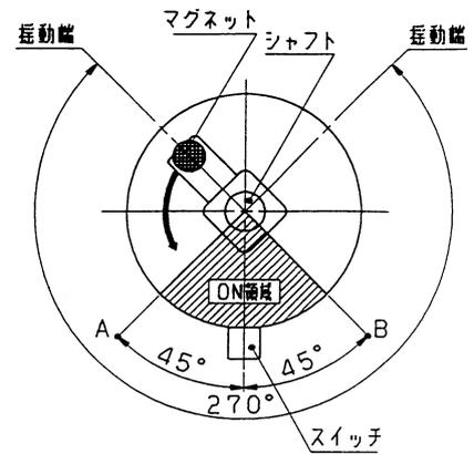
上図において、シャフトの揺動に合わせてマグネットが→印方向へ揺動した場合、マグネットがA点を通るとスイッチONとなりB点を通るとスイッチOFFとなります。この場合、ON領域が $90^\circ$ 、すなわちスイッチの動作角度が $90^\circ$ となります。
