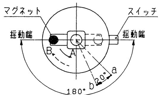
上図において、マグネットがA(実線)方向へ揺動した場合、a点でスイッチがONします。次に逆転させB(破線)方向へ揺動させるとb点でスイッチがOFFします。この時、a点とb点のヒステリシス $20^\circ$ が応差角度 $20^\circ$ となります。
